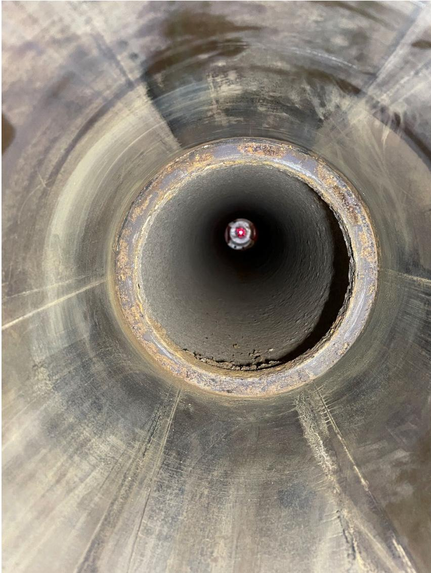
Zur Messung mittels Laser-Messverfahren wurden die Lagersitze leicht angeschliffen und gereinigt.
