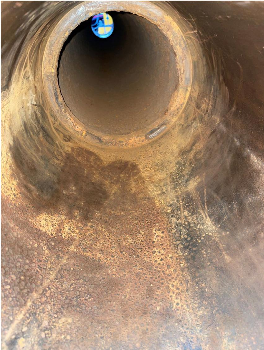
Starke Korrosion innerhalb der Lagersitze im Stevenrohrlager.
